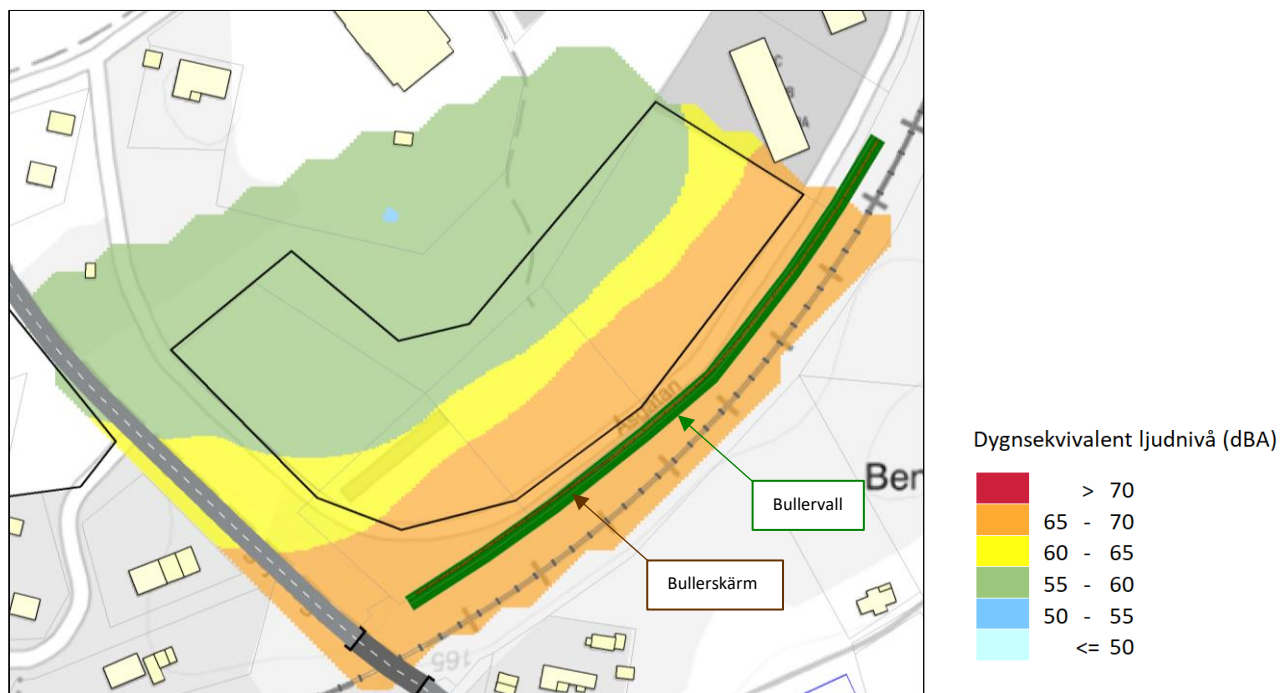
Figur 9. Åtgärdsförslag med bullerskydd som förlängts 40m i nordost och 40 m i sydväst. Bullervallen är 1,3 m hög och bullerskyddskärmen 2,5 m hög. Bullerkartan är beräknad på 17m höjd som motsvarar våning 6 på ett flerbostadshus.
